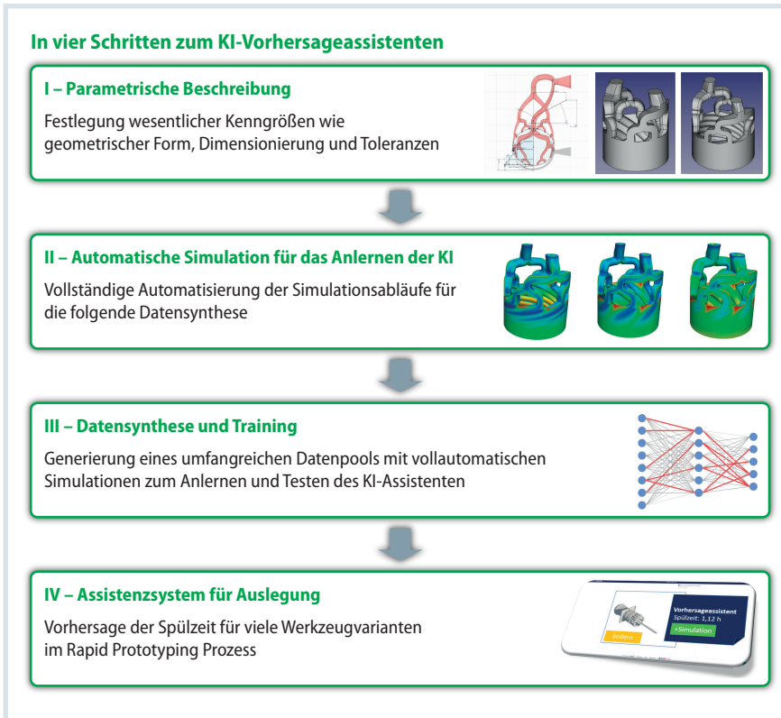
Bild 1. Werkzeugauslegung 4.0: Ianus hat einen intelligenten Workflow zur Herstellung von Extrusionswerkzeugen entwickelt. Quelle: Ianus; Grafik: © Hanser
